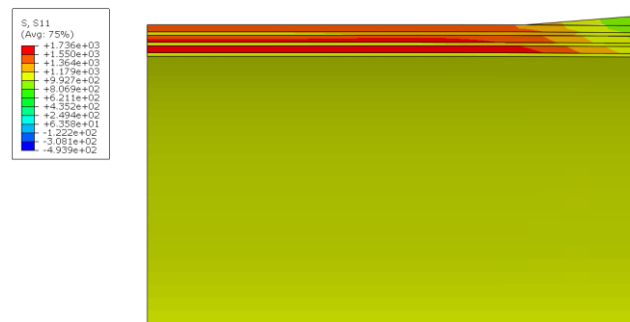
Abbildung 6: Spannungsverteilung in Faserrichtung im zylindrischen Tankbereich
