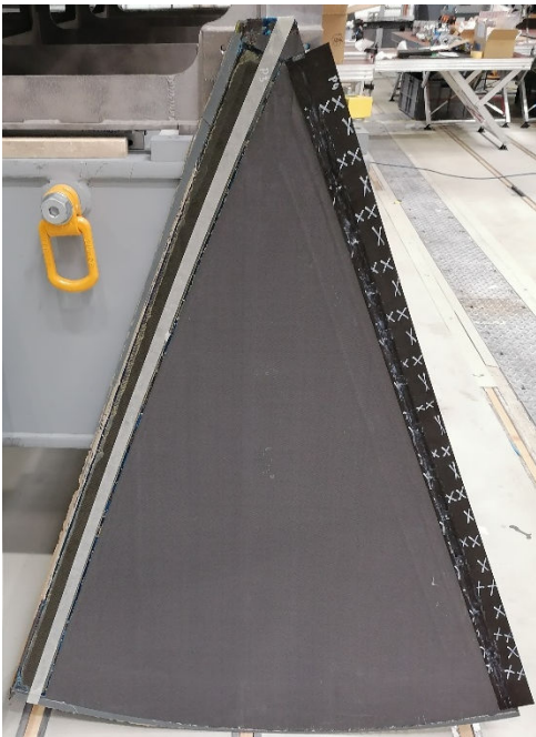
BILD 10. Duroplast-Thermoplast-Strukturbauteil, mit Oberflächenmodifikation, per Ultraschallschweißen gefügt [3]
