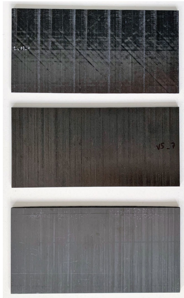
BILD 3. Lamine aus identischen CF und Matrix, aber mit unterschiedlichen Verarbeitungsverfahren hergestellt (von oben nach unten: AFP, thermogeformt, heißgepresst) [6]
