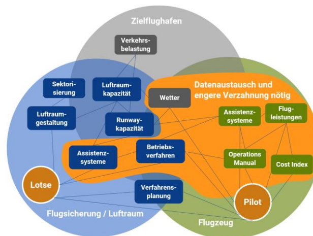
Abbildung 5: Abhängigkeitsdiagramm der verschiedenen Einflussfaktoren auf die Möglichkeiten einer optimierten vertikalen Flugführung (Ziel-Situation, orangefarben unterlegt der Anpassungsbedarf für die Vernetzung)
