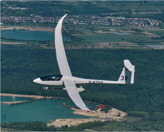
BILD 5. Versuchsflugzeug Ventus 3 TS im Flug mit montierter Messanlage.
