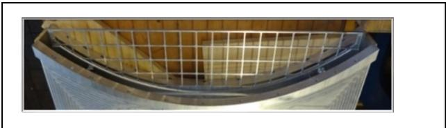
BILD 3: Einfahrbarer Störgitter Variante-6
