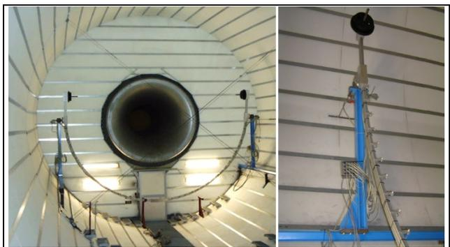
BILD 13: Mikrofonantenne in der akustisch reflexionsarm ausgekleideten Beruhigungskammer
