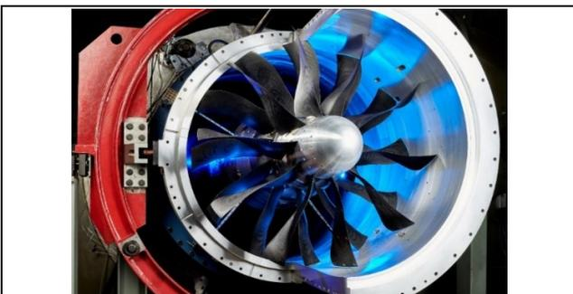
BILD 2: Gegenläufiger DLR-CRISPmulti Fan in CFK Bauweise
