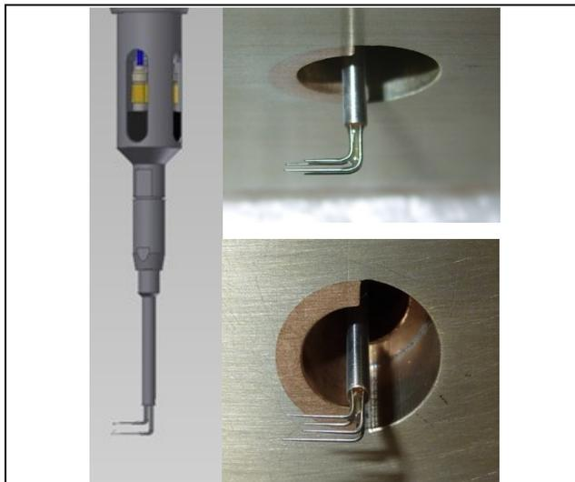
BILD 7: X-Draht Hitzdrahtsonden mit Beschleunigungssensoren zur Schwingungsüberwachung
