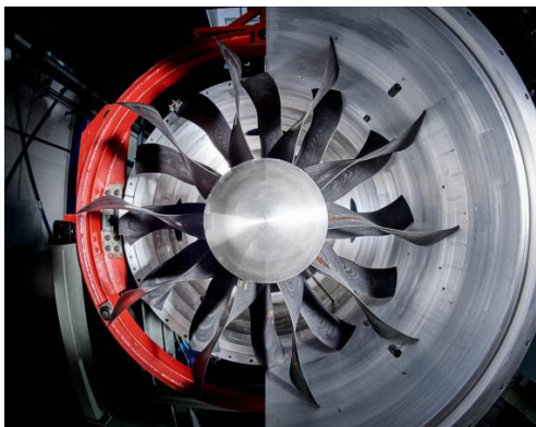
BILD 9. Gegenläufig rotierender Turbofan CRISPMulti in CFK-Bauweise.
