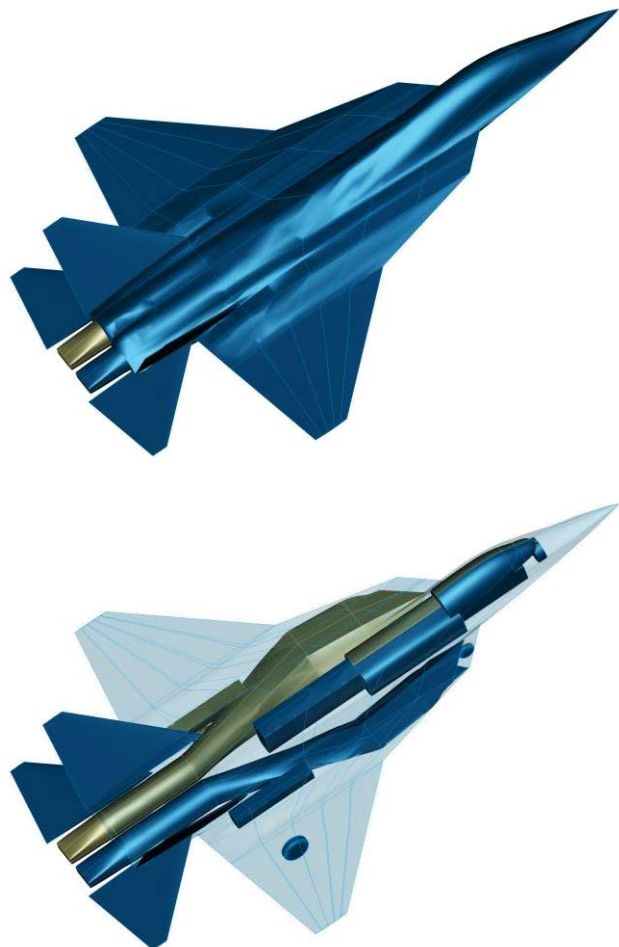
BILD 10. CPACS-Modell des DLR-FFD V3.0.0 oben: Außenansicht unten: Innenansicht
