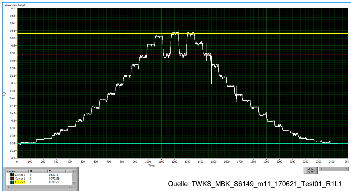
Bild 11. Rohdaten einer Messung mit dem Lasertriangulator.
