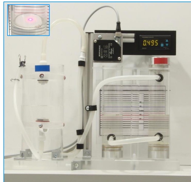
Bild 5. Manometer nach Betz mit Lasertriangulator. Kleines Bild: Schwimmer mit Laserstrahl.
