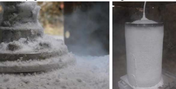
BILD 12. Kryotest Faserverbund Tanks
