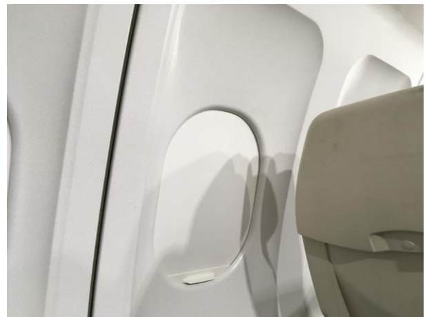
BILD 5. Abstand zwischen Wandelementen in der Flugzeugkabine
