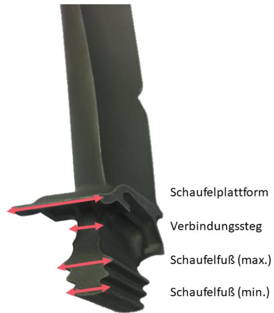
**BILD 4. Elemente und verwendete Nomenklatur im Schaufelfußbereich**
