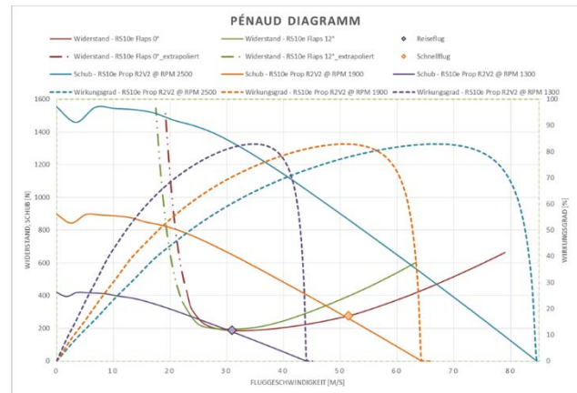
BILD 9. Erweitertes Pénaud-Diagramm für verschiedene Klappenstellungen und Drehzahlen, erweitert um Propellerwirkungsgrade
