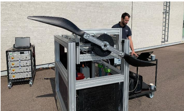
BILD 6. Bodenprüfstand für E-Antriebe
