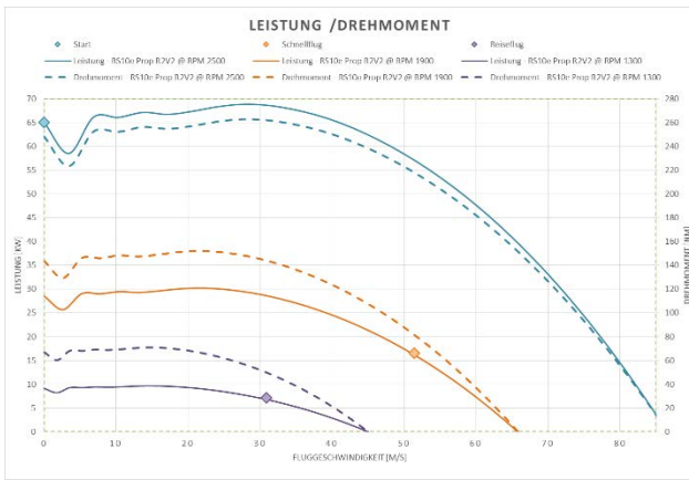
BILD 10. Leistung und Drehmoment für drei Drehzahlen als Funktion der Fluggeschwindigkeit
