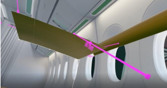
Abbildung 22: Griffweite zum Tisch aus Liegeposition. Quelle: Eigene Abbildung, 2020
