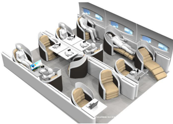
Abbildung 23: Multifunctional Seat Concept. Quelle: T.-M. Bock (DLR), 2020
