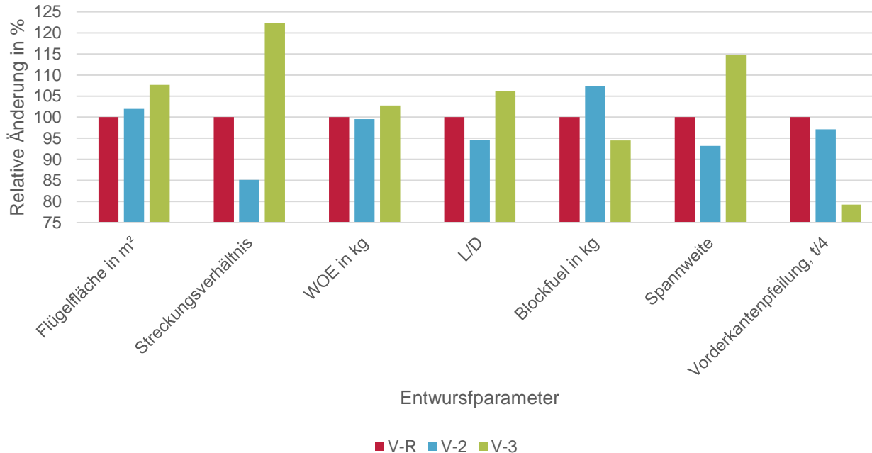
Entwurfsparameter im Vergleich zur Referenz V-R, BPR = 12
