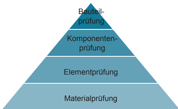
Bild 1: Mechanische Prüfung von Verbundstrukturen nach dem Building Block Approach
