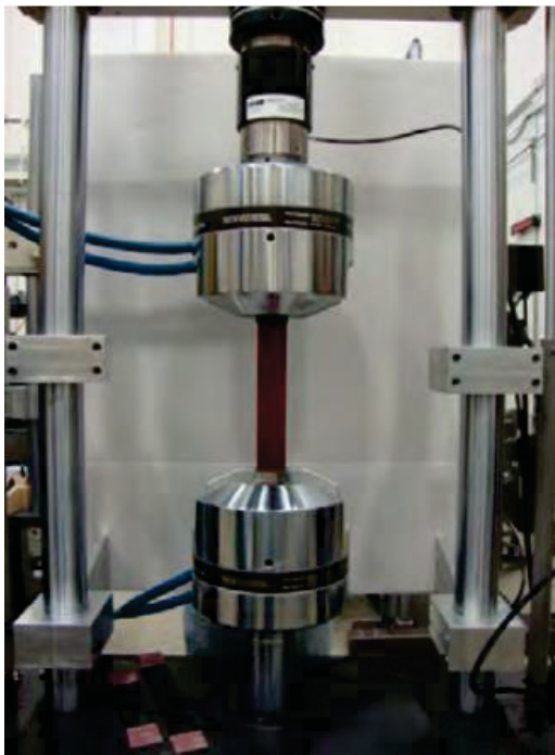
Abbildung 3-1: Eingespanntes Gurtelement zur Zugprobe [33]
