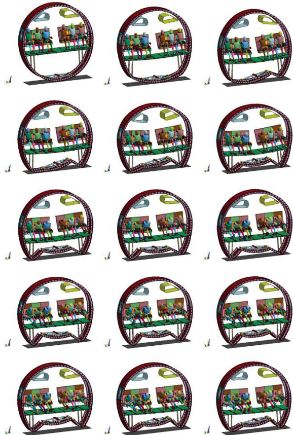
Abbildung 6-2: Kinematik des vertikalen Aufpralls der Rumpfsktion von 0 ms bis 350 ms (Schritt: 25 ms) (v. l. n. r. / v. o. n. u.)
