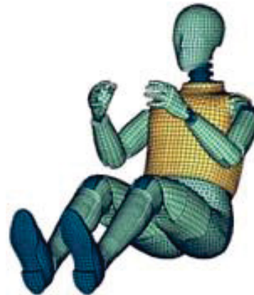
Abbildung 2-6: FE-Modell eines HIII-Dummys [26]
