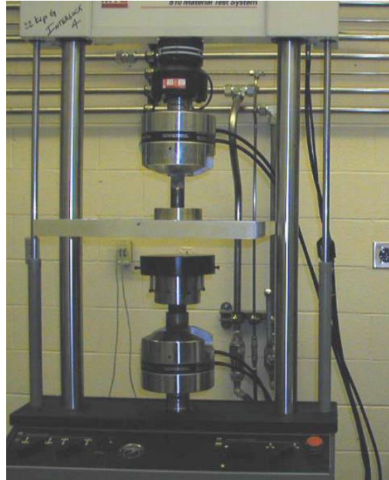
Abbildung 3-4: Testvorrichtung zur Polsterkalibrierung [34]
