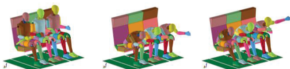
Abbildung 5-4: Kinematik des horizontalen Impulses nach 0 ms (l.), 160 ms (m.) und 260 ms (r.)
