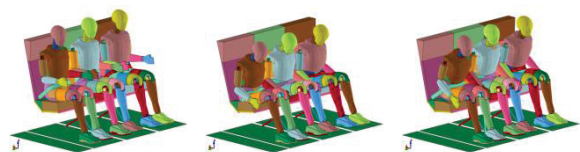
Abbildung 5-3: Kinematik des vertikalen Impulses nach 0 ms (l.), 130 ms (m.) und 260 ms (r.)
