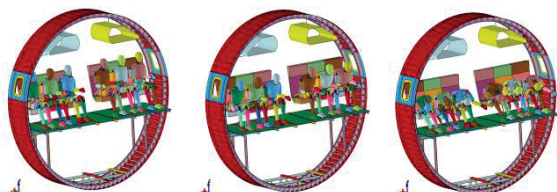
Abbildung 6-3: Kinematik der horizontalen Beschleunigung der Rumpfsektion
