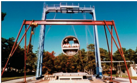
Abbildung 1-1: Testaufbau des Falltests [4]
