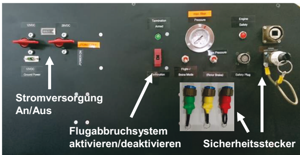
BILD 3 Bedienpanel am ALAADy-Demonstrator mit Sicherheitssteckern
