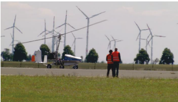
BILD 10 Umbenannter ALAADy-Demonstrator bei Rollversuchen mit drehendem Rotor
