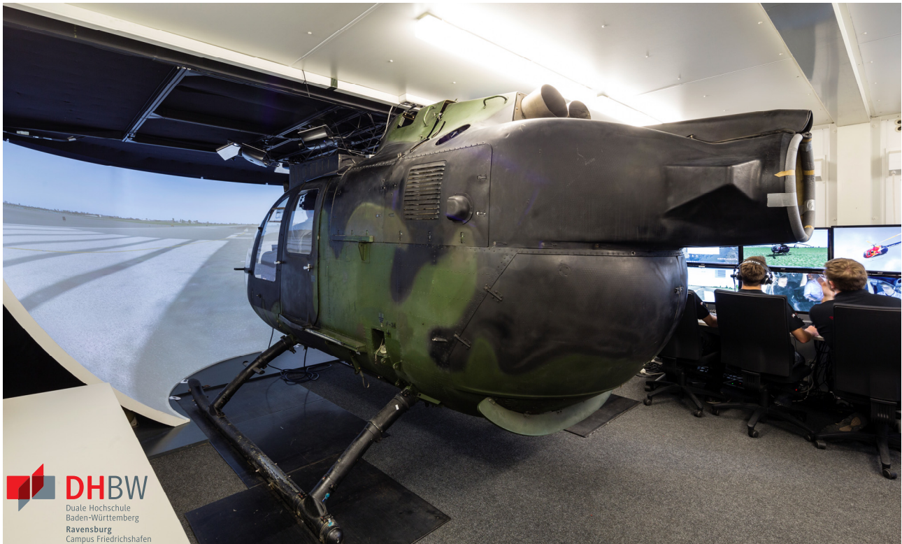
BILD 16. Hubschrauber Flugsimulator mit Projektionsfläche (erste Ausbaustufe) und Operator Station
