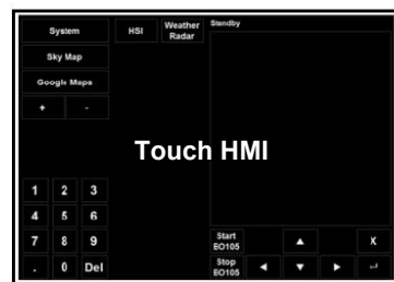
BILD 14. Konzept der Glass Cockpit Konvertierung mit Warnings und Cautions Anzeigen, Primary Flight Display (PFD), Multi Function Display (MFD), Engine Indication and Crew Alerting Display (EICAS), umschaltbarer Flight Map oder Google Maps, sowie Touch-fähigem Display (Human Machine Interface, HMI) im Center Pedestal [12]
