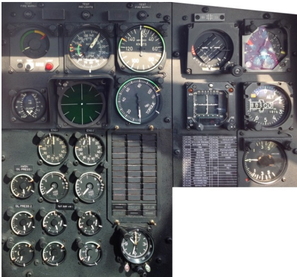
BILD 13. Original BO105 Instrumente, Zustand vor der Glass-Cockpit Konvertierung
