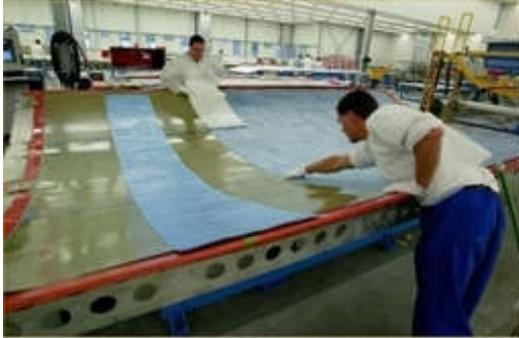
BILD 2: Manueller Fertigungsprozess der A380 Glare-Bauteile [7]
