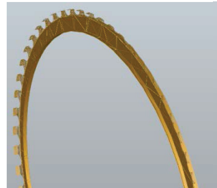
Test: Extrudiertes Spantprofil mit Ausschnitte für Stringer in OCC
