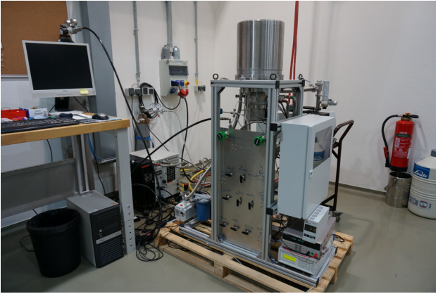
BILD 12. Versuchsaufbau mit Kaltkopf zur Untersuchung von Isolierungsproben
