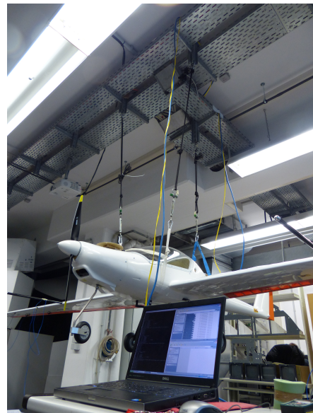
BILD 4: Aufhängung der G-Flights Dimona während der Standschwingversuche
