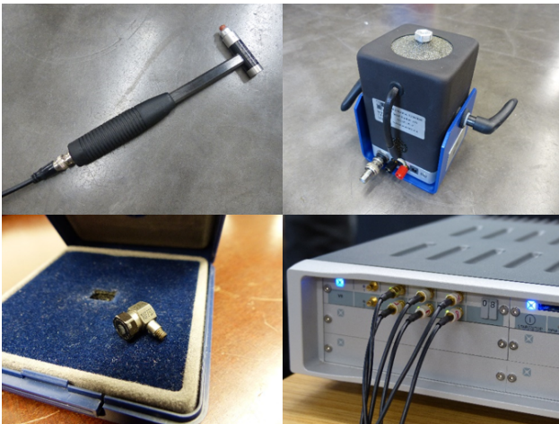
BILD 5: LMS-Messanlage: Hammer (o.li.), Shaker (o.re.), Beschleunigungssensor (u.li.) und LMS Scadas Recorder (u.re.)
