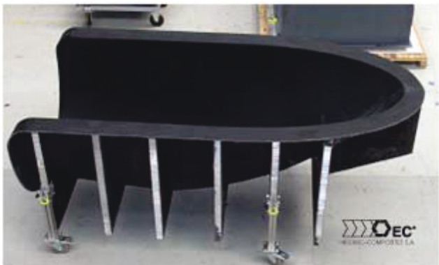
BILD 9: Autoklav-Werkzeug (mit frdl. Genehmigung von Euro-Composites S.A., Echternach/Luxembourg)
