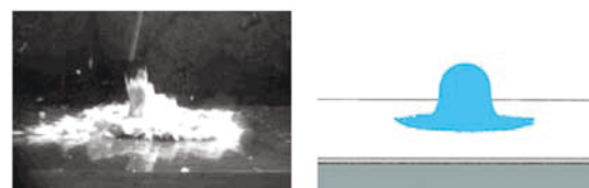
BILD 19: Vogelschlagversuch auf instrumentierte Platten mit Simulationsmodell
