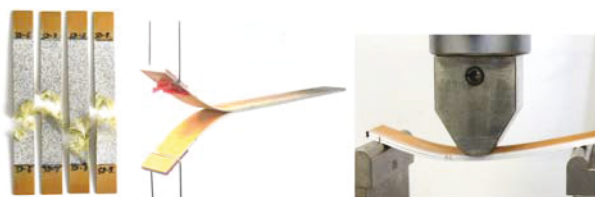
BILD 16: Couponversuche zur Charakterisierung des Sandwich-Deckschichtmaterials
