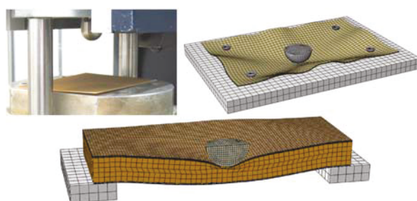
BILD 18: Fallturmversuch und Simulationsmodelle der Deckschichtproben (oben) und Sandwichproben (unten)
