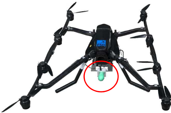
BILD 6. Anbindung des Radarsensors am Multirotor-system (rot umrahmt).
