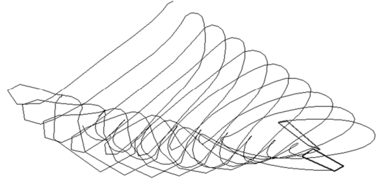
BILD 10. Wirbelfeld am einzelnen Propeller bei V_A = 12 m/s und \alpha = 0^\circ
