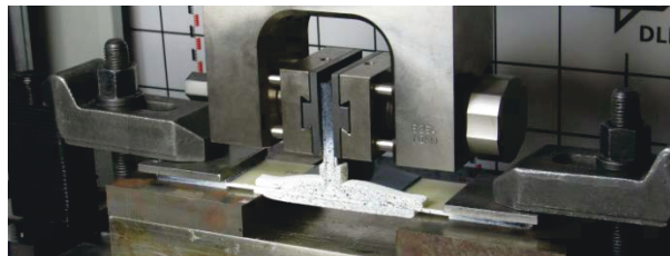
BILD 23. Versuchsaufbau für die Stringerproben
