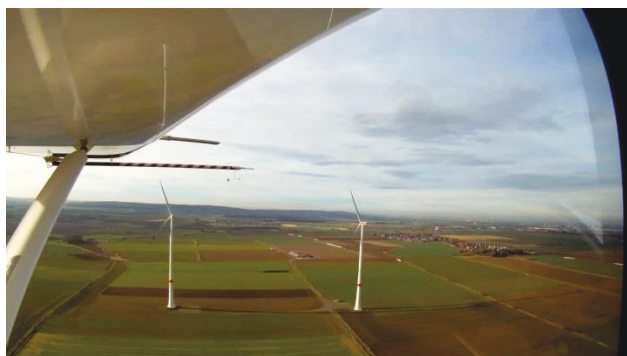
Bild 11. Cockpitblick bei einem Fly-By im Abstand von ca. 6 Rotordurchmessern leeseitig zu den WEA; Strömungssensorik (Windmessstationen) sichtbar am linken Außenflügel
