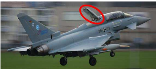
BILD 3. Bremsklappe, als Demonstratorstruktur „Strukturelle Klebertechnologie“
