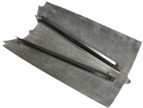
BILD 9. Außenschale der Bremsklappe mit geklebten Versteifungselementen.
