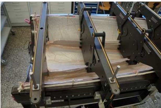
BILD 8. Am DLR Braunschweig entwickelte Vorrichtung zur Klebung der Versteifungselemente der Bremsklappe
