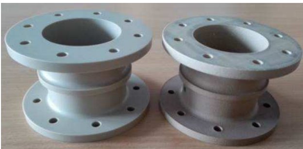
BILD 26. Original Isolatorbauteil (links) und ALM gefertigtes Bauteil (rechts)
