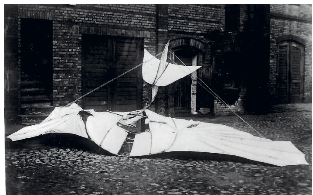
Bild 19. Der beim Absturz zerstörte Gleiter
