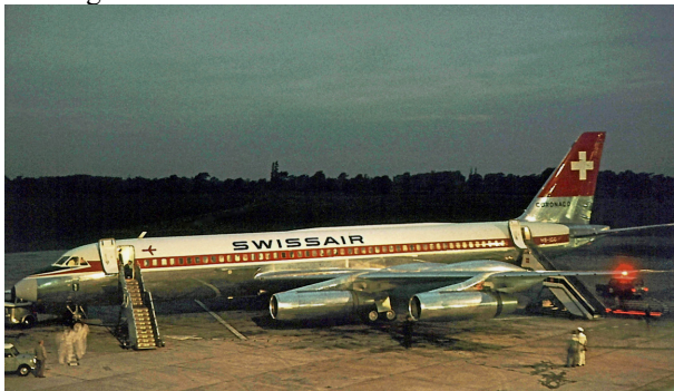
Abbildung 49: Convair 990 „Coronado“. Erstflug: 24.01.1961 Liniendienst: 7. Januar 1962 (AA) Triebwerk: GE CJ805-23B (Aft-Fan)
