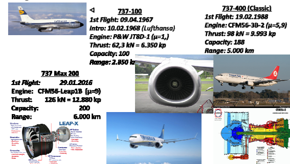
Abbildung 65: Boeing B 737 Die 3 wesentlichen Entwicklungsschritte durch jeweils neue Antriebsgenerationen: PW JT8D > CFM56 > CFM56 Leap
