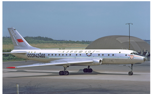
Abbildung 51: Tupolev Tu-104 (NATO: „Camel“). Erstflug: 17.06.1955. Einsatz: 15.09.1956 . Fertigung: 1956 -1960 Anzahl: ca. 200. Triebwerke: 2 x Mikulin AM-3M
