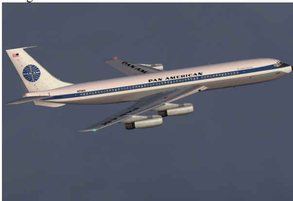
Abbildung 41: Boeing 707. Erstflug: 20.12.1957. Einführung: Oktober 1958, Triebwerke: 4 x Pratt & Whitney JT3C (J57)
