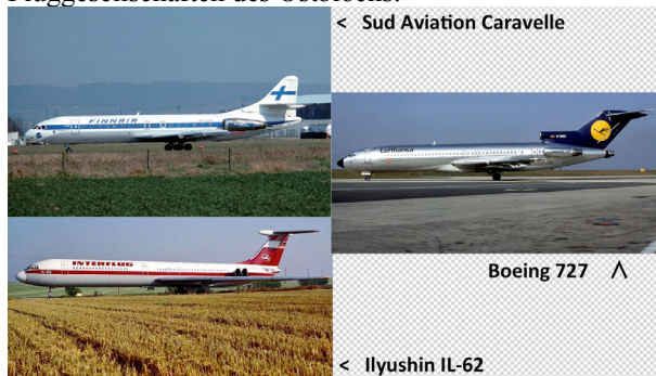
Abbildung 52: Heckanordnung der Strahltriebwerke
