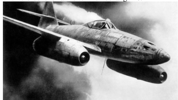
Abbildung 7: Messerschmitt Me 262, zweistrahliges Jagdflugzeug mit gepfeilten Flügeln.
