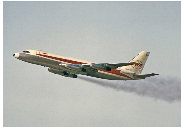
Abbildung 46: Convair CV880 "Golden Arrow" der Consolidated Vultee Aircraft Corporation. Erstflug: 27.01.1959. Einführung: Mai 1960 (Delta) Antrieb: 4 x General Electric CJ-805-3 Strahltriebwerke
