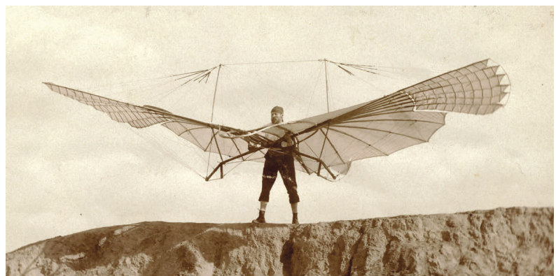
Lilienthals "kleiner Flügelschlagapparat" aus dem Jahr 1894
