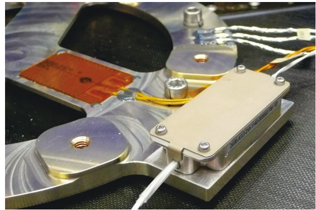
BILD 1. Beispiel eines linearen Heizerkreises mit Heizmatte (links) und Heizregler (Heater Control Element HCE, rechts)
