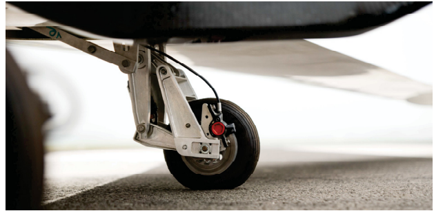
BILD 5: Hauptfahrwerk mit Radbremse
