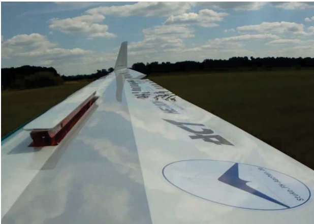
BILD 6: Landeanflug mit Störklappe
