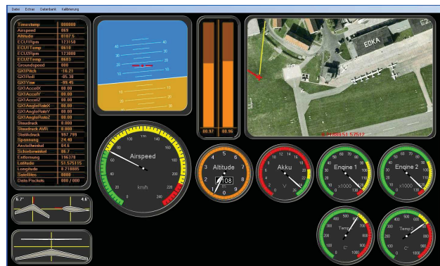
BILD 7: Virtuelles Cockpit in der Bodenstation
