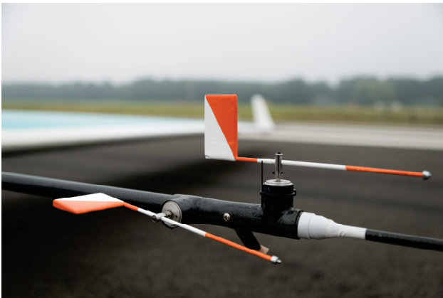
BILD 4: Anstell- und Schiebewinkelsensor an der Messlanze
