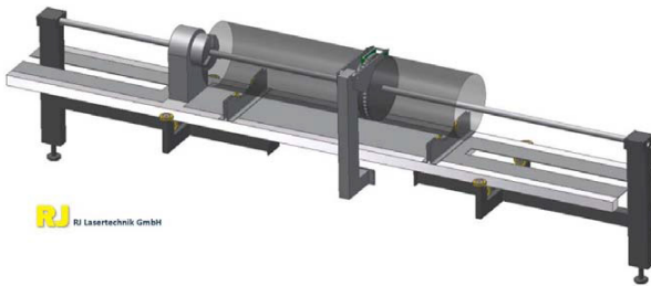
BILD 17: Gerundetes Blech in Bohrvorrichtung
