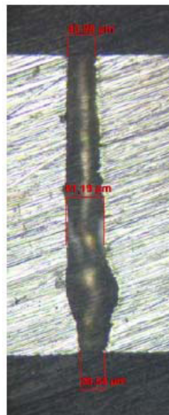
BILD 16: Bohrkanal bei Perkussionsbohren
