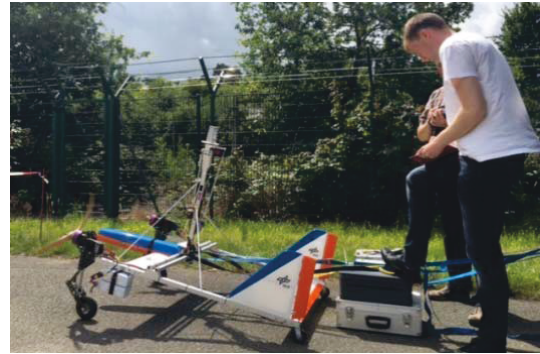
Abbildung 8: Aufbau der Standschubmessung
