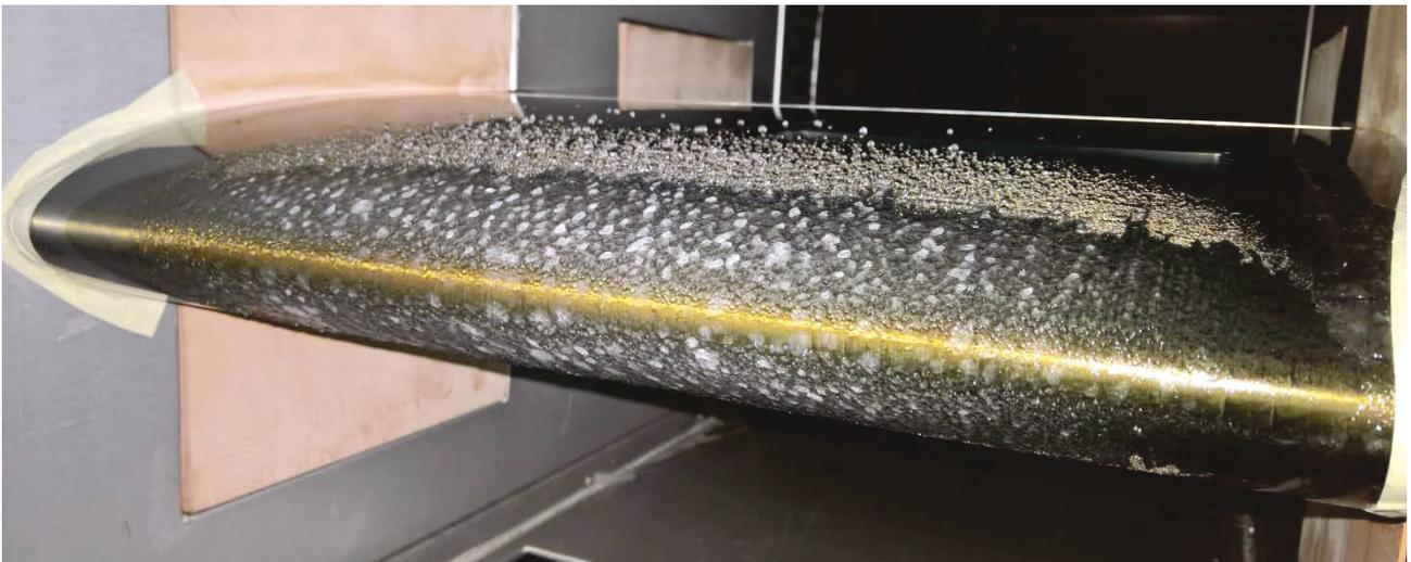
BILD 16: Typischer Eis Aufbau. Entlang der Staulinie Klareis, in Profiltiefenrichtung dann Mischeis und nadelförmige Spitzen.
