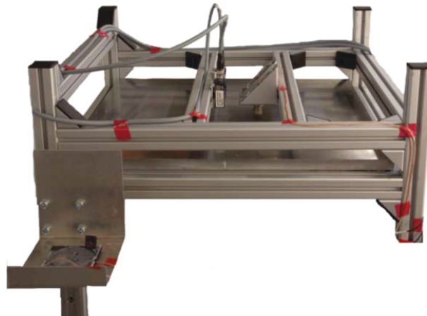
Abbildung 6: Versuchsaufbau zur Ermittlung der Federsteifigkeit [8]
