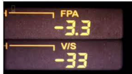
BILD 1. Darstellungsvergleich Flugbahnwinkel vs. Vertikalgeschwindigkeit
