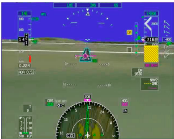
BILD 5. Primary Flight Display mit Synthetic Vision System
