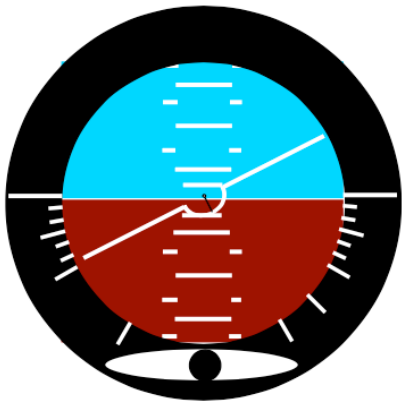
BILD 2. Russischer künstlicher Horizont
