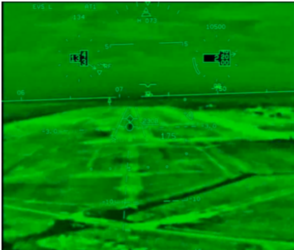
BILD 4. Head-Up Display mit Enhanced Flight Vision System
