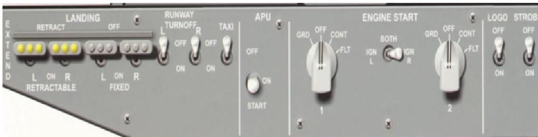
**Abbildung 2 - Boeing 737 Overhead Panel – Schalter „nach vorne“ an – diese Stellung ist aber „physisch“ eher „unten“**(flightsim.com)
