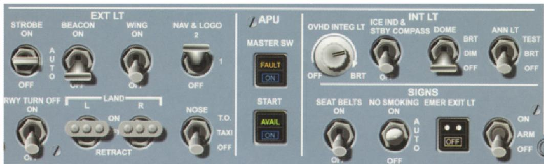
**Abbildung 3 - Airbus A320 Overhead Panel – Schalter „nach oben“ an** (flightsim.com)
