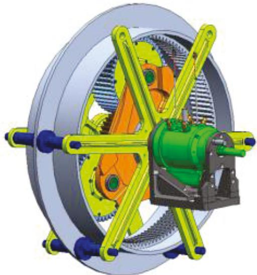
BILD 11. Rigtestaufbau für Planetengetriebe
