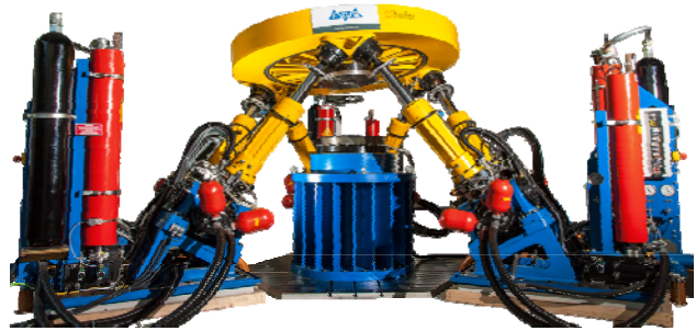
BILD 3. Hexapod-Prüfstand am Institut PKT der TUHH
