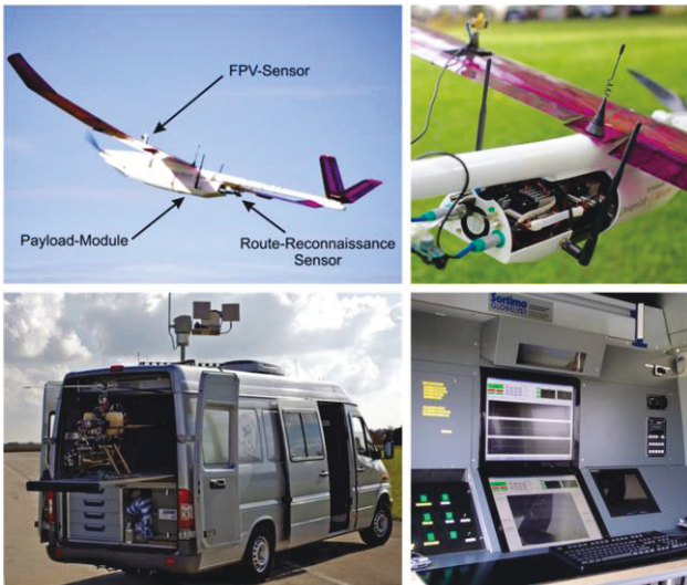
BILD 11. COSA 2 Flugversuche an der UniBwM. Oben: Graphite Flugversuchsträger. Unten: Mobile Bodenkontrollstation [27].
