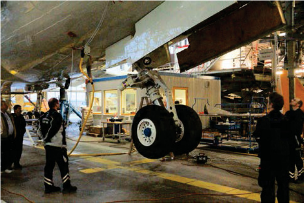
Bild 17: Gear swing of nose gear
