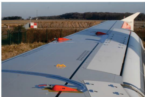
BILD 9. (Links) Die Sondenmodule auf der Saugseite des Flügels; (Mitte) Die Versorgungsmodule auf der Druckseite und (Rechts) der Steuerrechner in der Kabine
