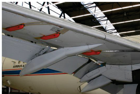
BILD 9. (Links) Die Sondenmodule auf der Saugseite des Flügels; (Mitte) Die Versorgungsmodule auf der Druckseite und (Rechts) der Steuerrechner in der Kabine
