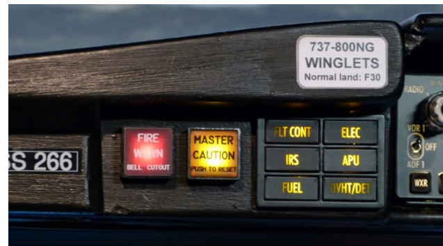
BILD 2 Fire Warning und Master Caution im Boeing 737 Cockpit ( http://b737home.blogspot.de/ )
