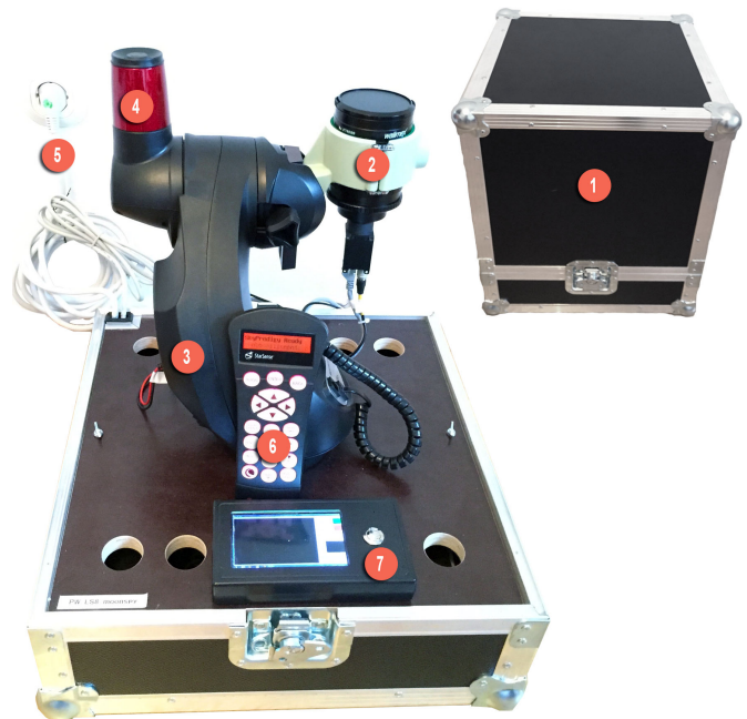
Abb. 1: Moonspy - autonomes TLP Beobachtungssystem
