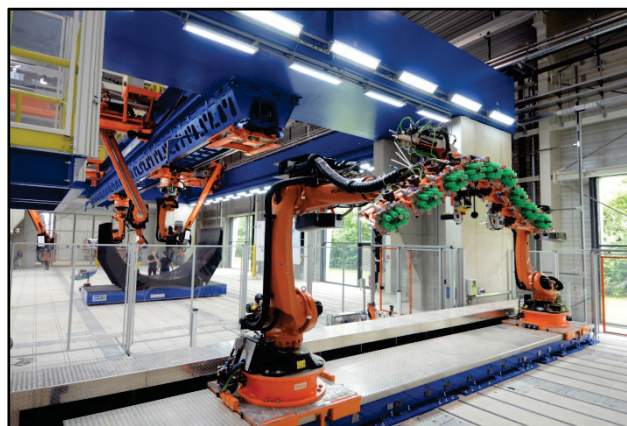
BILD 2. Die Technologie Erprobungszelle (TEZ) im Vordergrund mit zwei Robotern auf einer Linearachse und mit einem Robotik-Portalsystem (MFZ) im Hintergrund.
