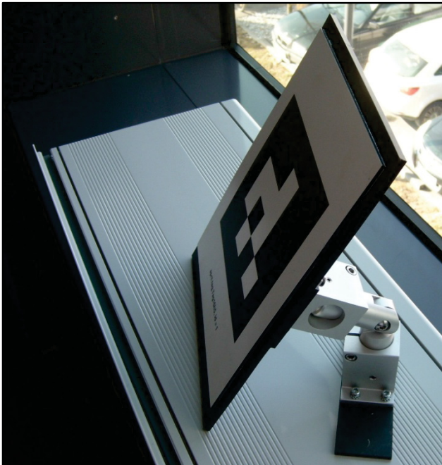
BILD 5. Die Befestigung des AprilTag-Markers auf der Marker Grundplatte (links) sowie das bewegliche Verbindungsgelenk und die Fußplatte.
