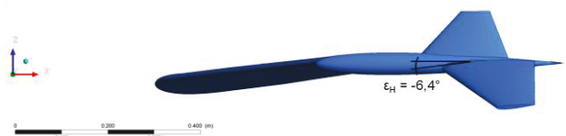
BILD 9. Flugzeugmodell mit einem Einstellwinkel \epsilon_H = -6,4^\circ am Randleitwerk
