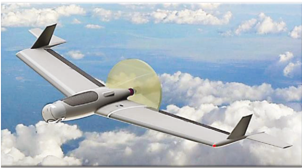
BILD 13. Studie zur Sensorintegration in eine RLW-Konfiguration
