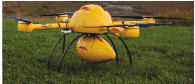
BILD 7. Das unbemannte Fluggerät mit angebautes LoRa-Funkmodul (weiß)
