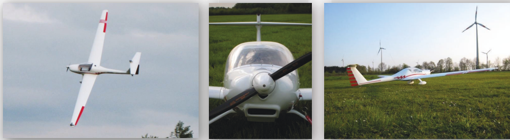
ULTRA-Dimona – unbemannter Flugversuchsträger
